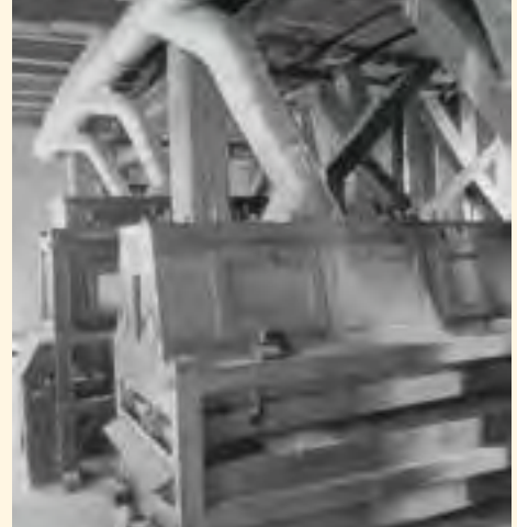
Mulino a cilindri con laminatoi e tubi di trasporto delle granaglie dai silos
